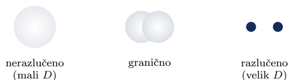
Slika 4.2: Moć razlučivanja. Mali teleskop dvije bliske zvijezde vidi kao jednu mrlju (lijevo); veći teleskop ih razdvaja u dvije točke (desno). Granica je dana Rayleighovim kriterijem \theta = 1,22 \lambda/D .
